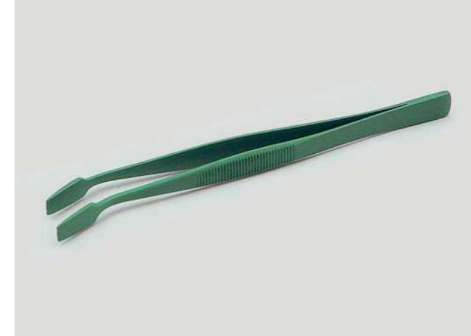
PINZA KUENHE PER VETRINI IN PTFE Pinza con punte curve. Lunghezza totale 105 mm. PTFE KUEHNE FORCEP Forcep with curved tips. Total length 105 mm.
